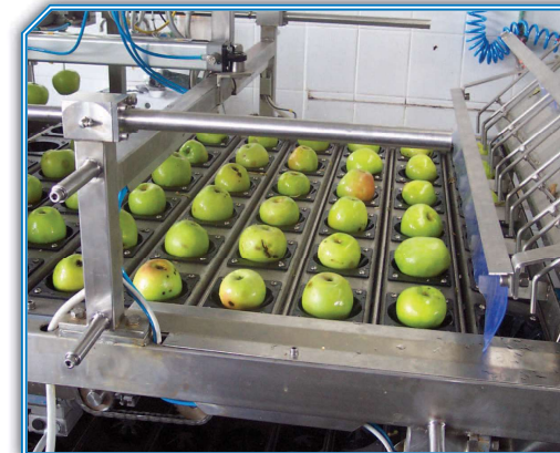
Dettagli alimentatore Mele Apple feeder details
